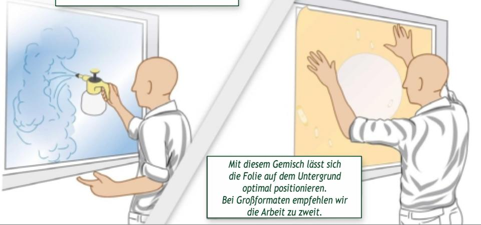
Mit diesem Gemisch lässt sich die Folie auf dem Untergrund optimal positionieren. Bei Großformaten empfehlen wir die Arbeit zu zweit.
